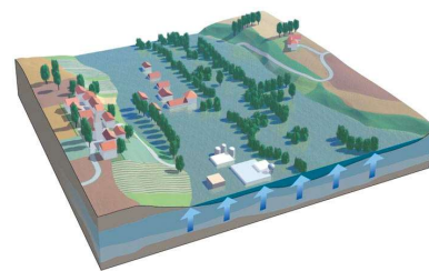
Inondation de nappe
