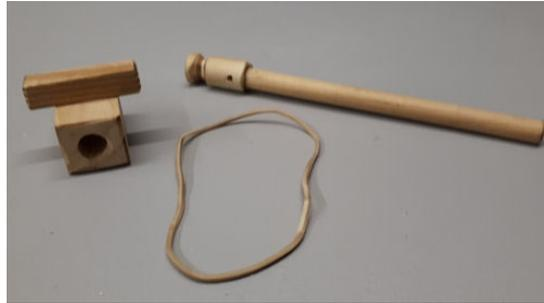
Ici, le piston est constitué d'une baguette ronde de 10 mm de diamètre, enfichée et collée dans un morceau de baguette percée de 13 mm de diamètre et qui fait office de butoir de fin de course.
